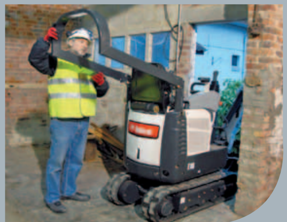
De beide modellen zijn uitgerust met een plooibare TOPS-structuur.
